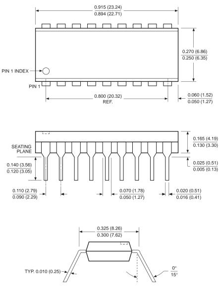
18-LEAD PLASTIC DUAL IN-LINE PACKAGE TYPE P
